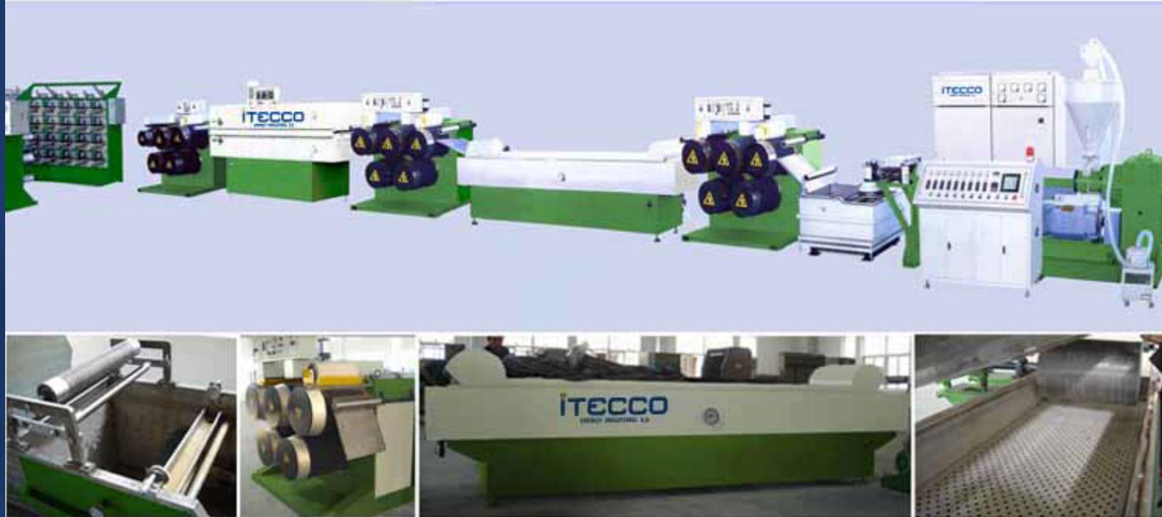
La línea de extrusión es controlado y PC. Se usa una técnica avanzada. La materia prima pasa por la extrusora, el tanque de carga y cinco rodillos, a continuación, introduce en el tanque de agua caliente y fuelles caliente para la calefacción y la segunda hasta terminar en un 5 cilindros, al final son rodillos rollo hilo. El ajuste de producción para fabricar hilo redondo de plástico para producir la cinta, malla, toldo, la construcción de proteger la red y así sucesivamente.
